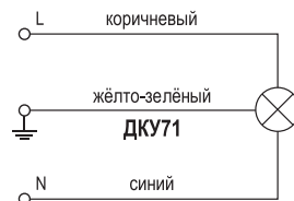
Рисунок 3. Схема присоединения светильника ДКУ71
